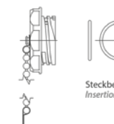
Schutzkappe für Stecker Protective cap for connector
